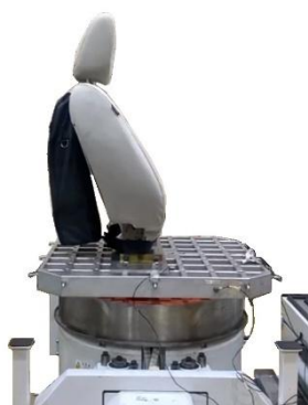
図1 振動耐久試験時の様子
