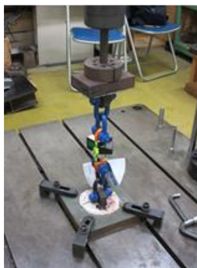
図 2 疲労試験の様子
