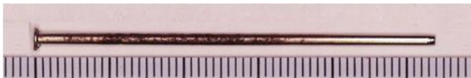
図 1 さびが多く発生したピン
