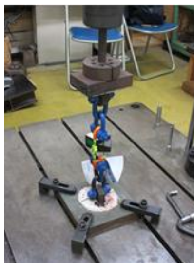
図 2 疲労試験の様子
