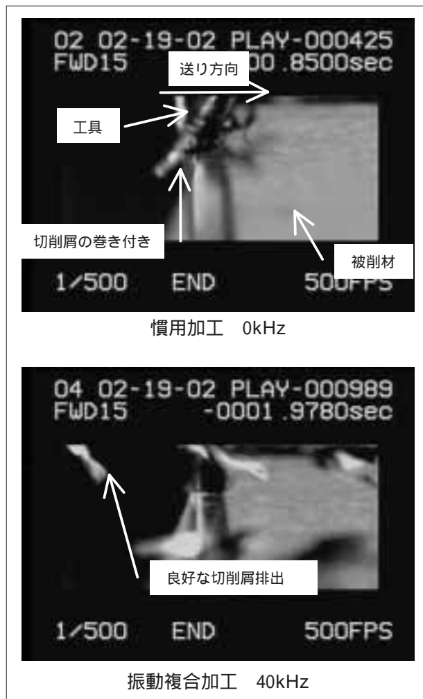
切削速度6.28 m/min 送り速度40mm/min 軸方向切り込み1mm Dry 写真3 加工中の切削屑状況
