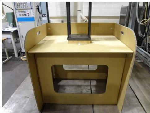
繰り返し荷重試験装置による試験
