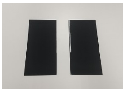
ガラスコーティング剤を塗布した自動車塗装板
