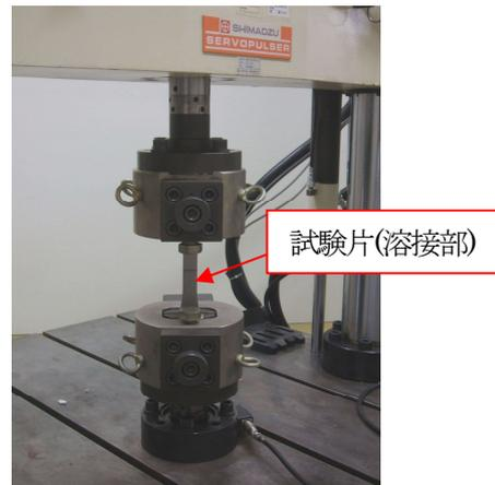
図2 ディスクファイバーレーザー溶接により作成した試験片の疲労試験
