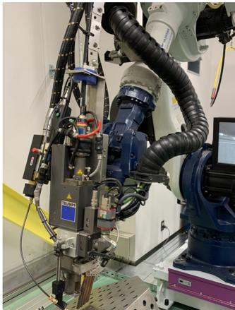
図1 ディスクファイバーレーザー溶接によりパネルを接合している様子
